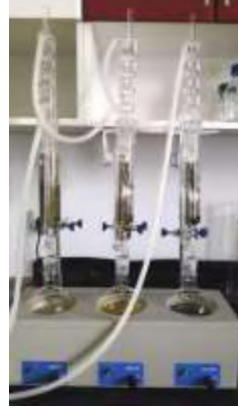
Resim 3.1. Soxhlet özütör cihazı (3'lü balon)
