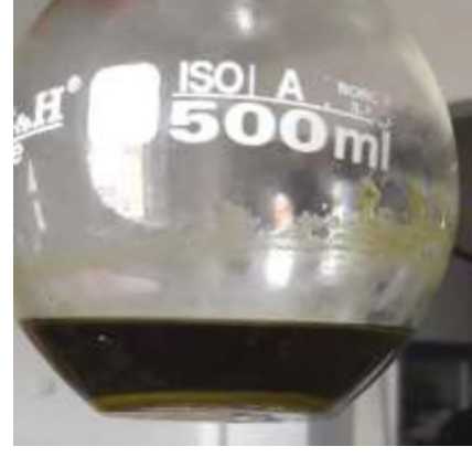
Resim 3.2. Soxhlet özütleme işlemi sonrası çözücüsü belli bir seviyeye gelene kadar uzaklaştırılan ve balon jode kalan özüt
