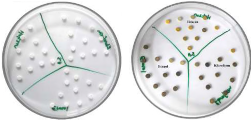
Resim 3.3. Standart boş antibiyotik disklere özütlerin emdirilmesi
