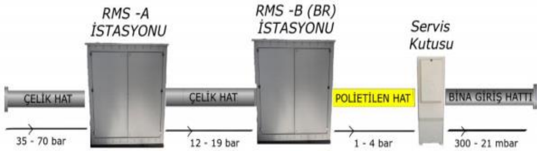
Şekil 2.7. Eysel ve düşük tüketimli hatların doğal gaz ana şebekeden beslenmesi(Kınacı, 2019)
