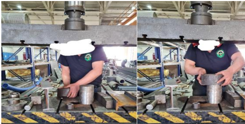
Resim 3.49. Preslenecek malzemenin yerleştirilmesi işlemi
