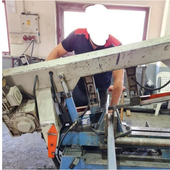
Resim 3.32. Demir testeresi profil kesilmesi işlemi
