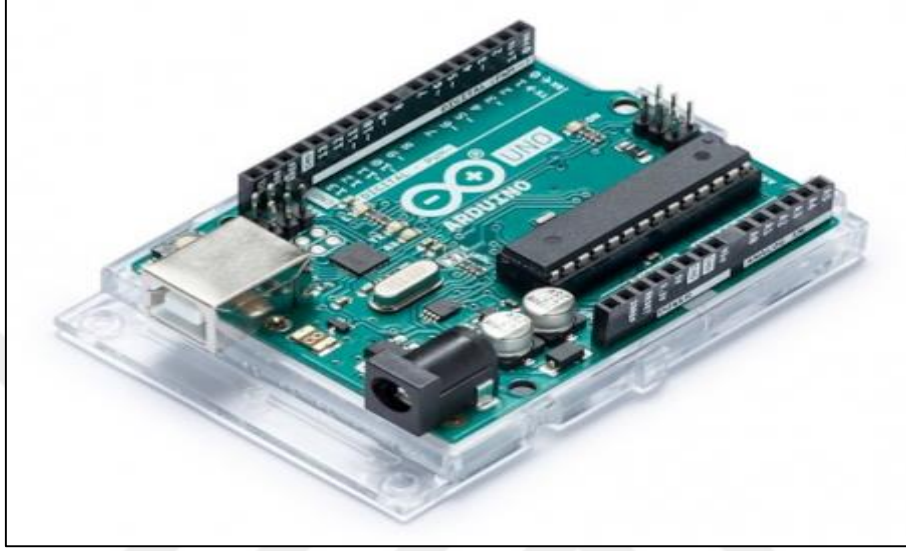
Resim 2.4. Arduino Uno R3 geliştirme kartı
