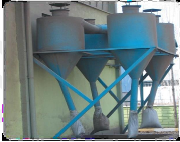
Resim 2.1 Toz toplama silolarının yüzeyinde biriken asbest tozu (Arseven, 2005).
