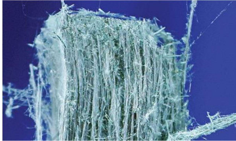
Resim 1.5 Krokidolit Asbest (Aslantaş, 2018).
