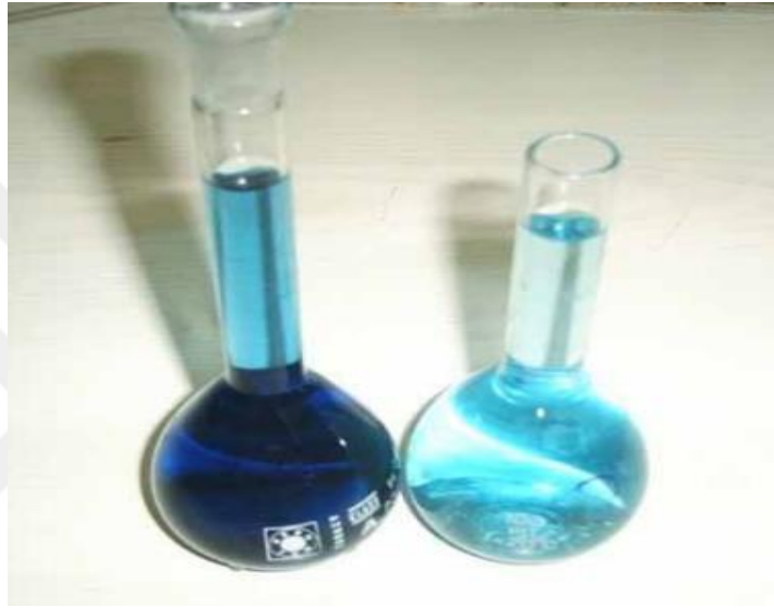
Fotoęraf 6.3. Numune içerisine kalay klorür ilave edilmesinin ardından numunedeki renk oluşumu. Oluşan rengin yapısının şiddeti numune içerisindeki fosfor konsantrasyonuna baęlıdır.
