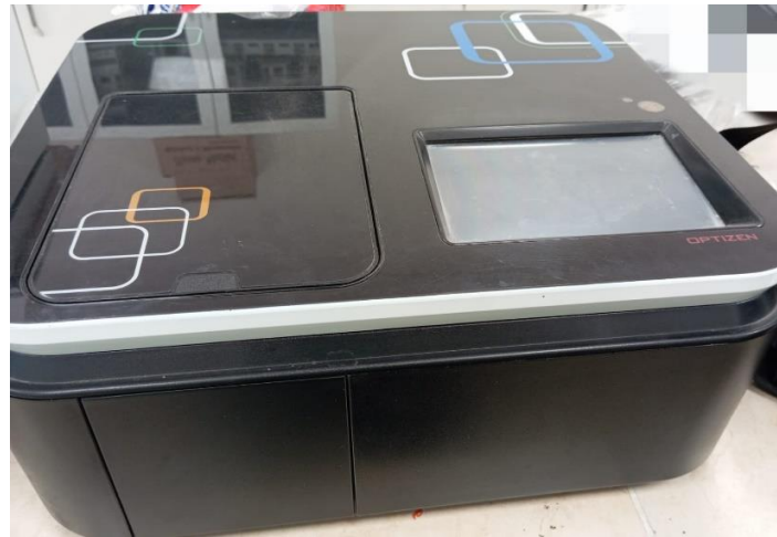
Fotoğraf 6.1. Ultraviyole Görünür Bölge Spektrofotometre cihazının gösterimi.
