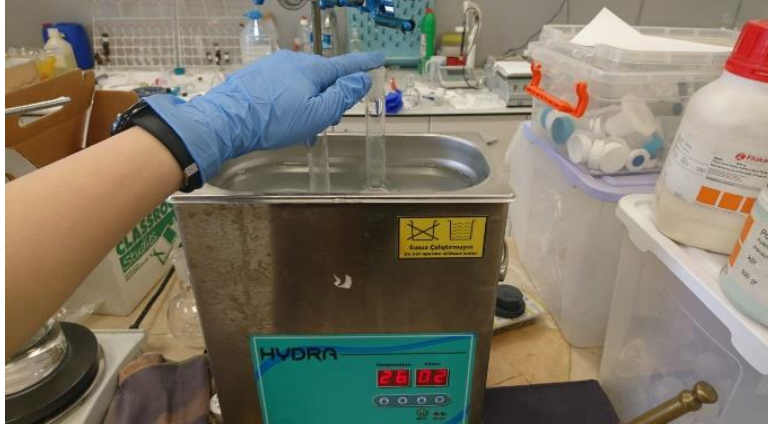
Fotoğraf 7.8. Eklenen maddelerin çözelti içinde karışmasını sağlamak için su dolu küvete alınıp 10 dakika ses dalgaları ile titreşime tabi tutulması.
