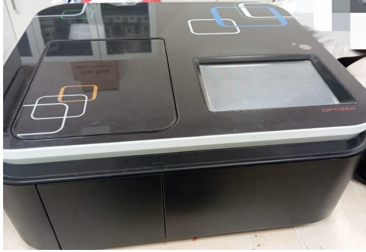
Fotoğraf 6.4. Numuneler görülen 1 cm ışık yollu küvet içerisine konularak spektrofotometre ile ölçümleri yapılır.
