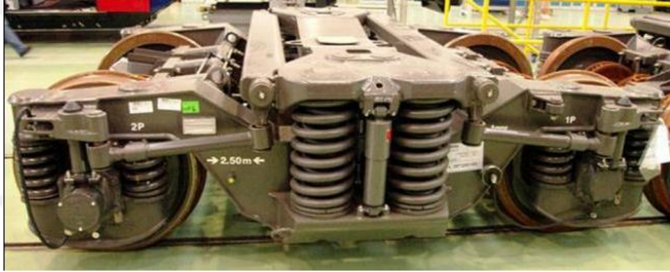
Resim 2.2. İki akslı konvansiyonel yolcu vagonu bojsi (Bilgin, 2015)
