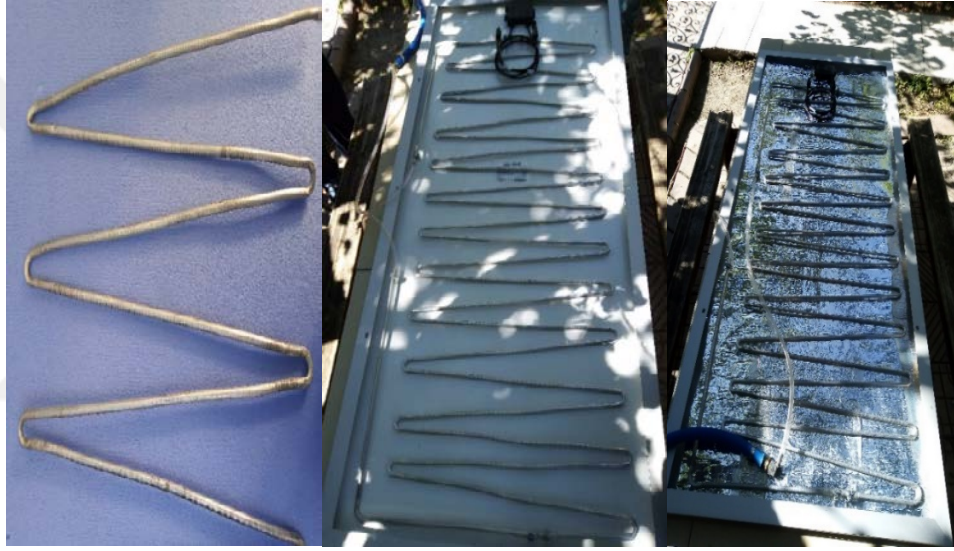
Resim 3.7. Fotovoltaik modül arka yüzeyine soğutma sisteminin montaj aşamaları
