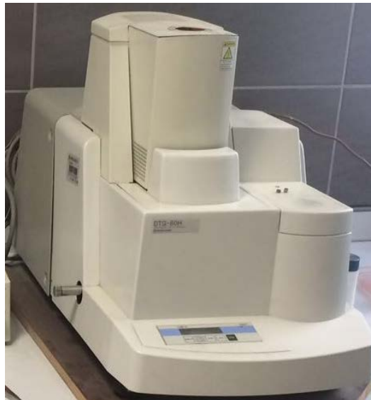
Resim 3.6. Diferansiyel termal gravimetre cihazı
