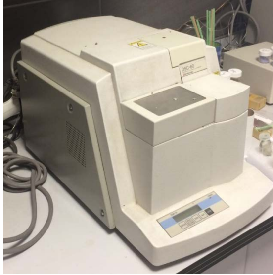
Resim 3.7. Diferansiyel tarama kalorimetresi
