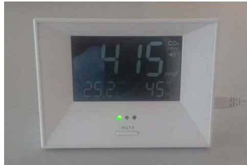
Resim 3.10. Karbondioksit ölçüm cihazı
