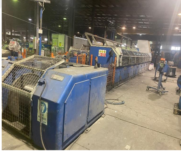
Resim 4.1. Apaydın metal firmasında kullanılan düşük karbonlu çelik ve kuru tel çekme makinesi
