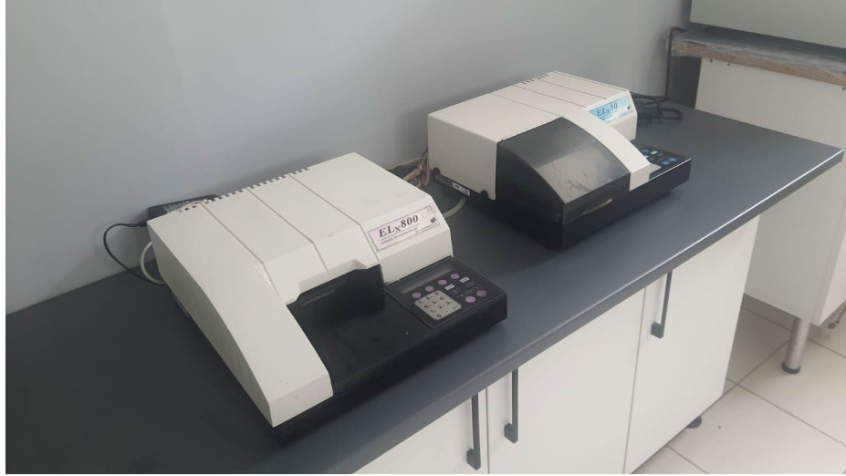
Resim 1. Innopenta Biyoteknoloji Laboratuvarı'nda BIOTEK marka ELX800 model ELISA Okuyucu Cihazı
