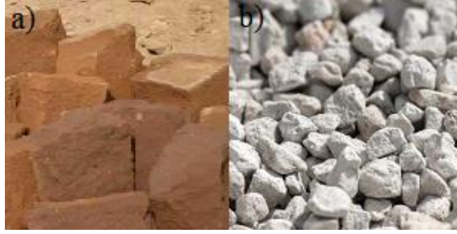
Şekil 4.2. Orijinal başlangıç malzemeleri a) Ahlat taşı b) pomza taşı
