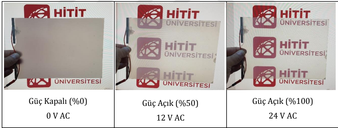
Resim 4.1. Uygulanan farklı AC gerilim seviyeleri için PDLC film görünüşleri
