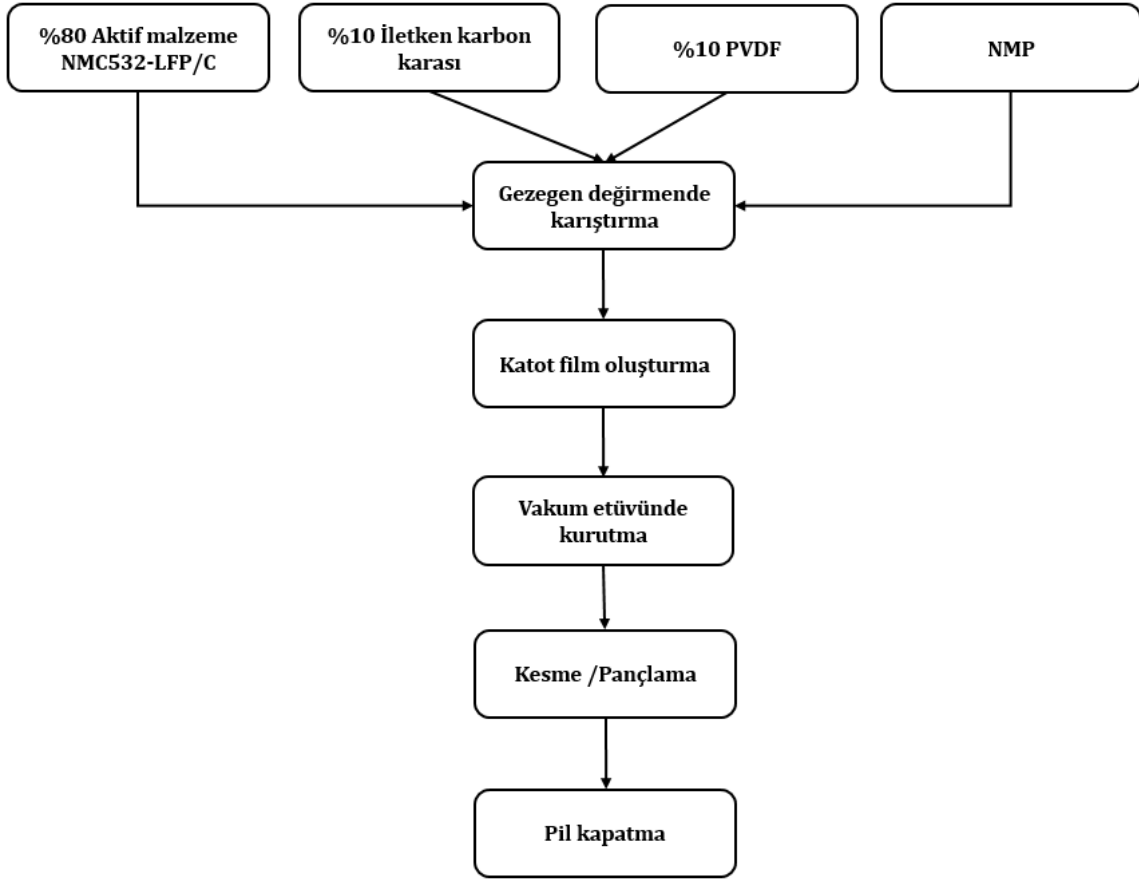
Şekil 2.3. Lityum-iyon piller için katot hazırlama akış şeması.
