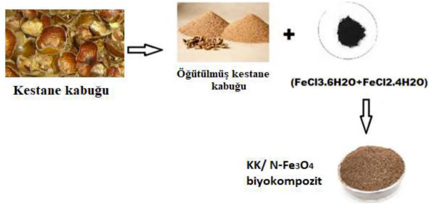
Şekil 5.1 KK/N-Fe 3 O 4 biyokompozitinin hazırlanması
