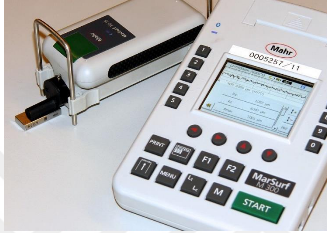
Resim 4.3. Marsurf/M300 Portatif 2B Profilometre
