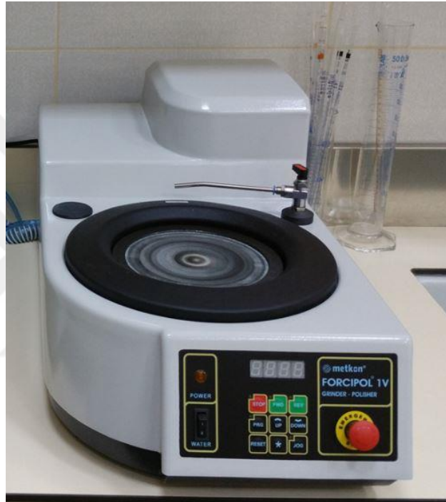
Resim 4.1. Metkon FORCIPOL 1V parlatma ve zımparalama cihazı
