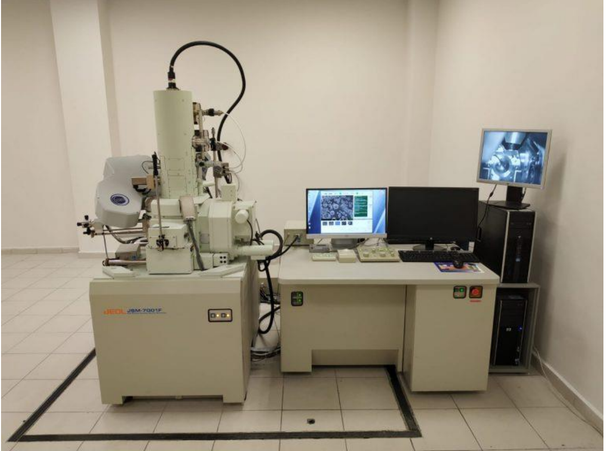
Resim 4.4. Jeol JSM7001F taramalı electron mikroskobu (SEM, scanning electron microscope)
