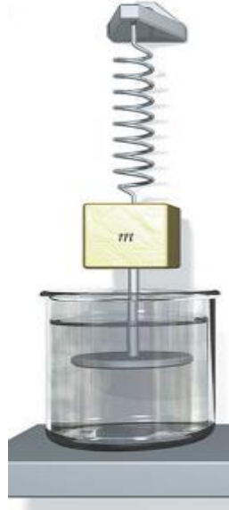
Şekil 1.2. Sönümlü Kütle Yay Sistemi
