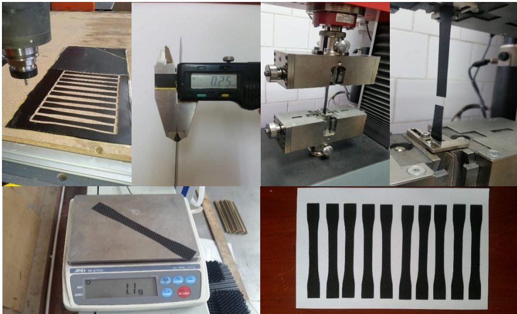
Resim 3.1. KFTP kompozit çekme numunelerinin hazırlanması ve örnek çekme deneyinden görüntüler
