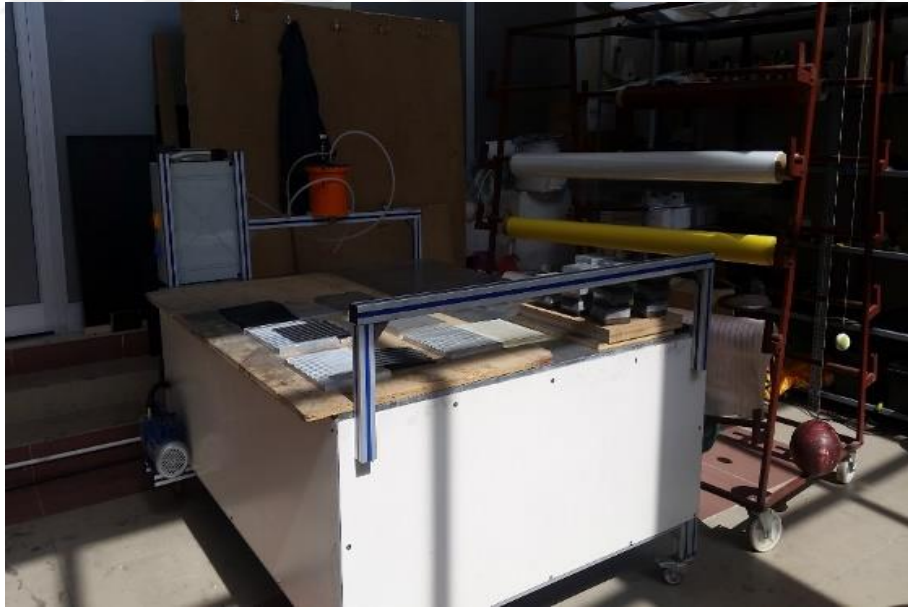
Resim 2.8. Sıcaklık kontrollü vakum infüzyon üretim ünitesi
