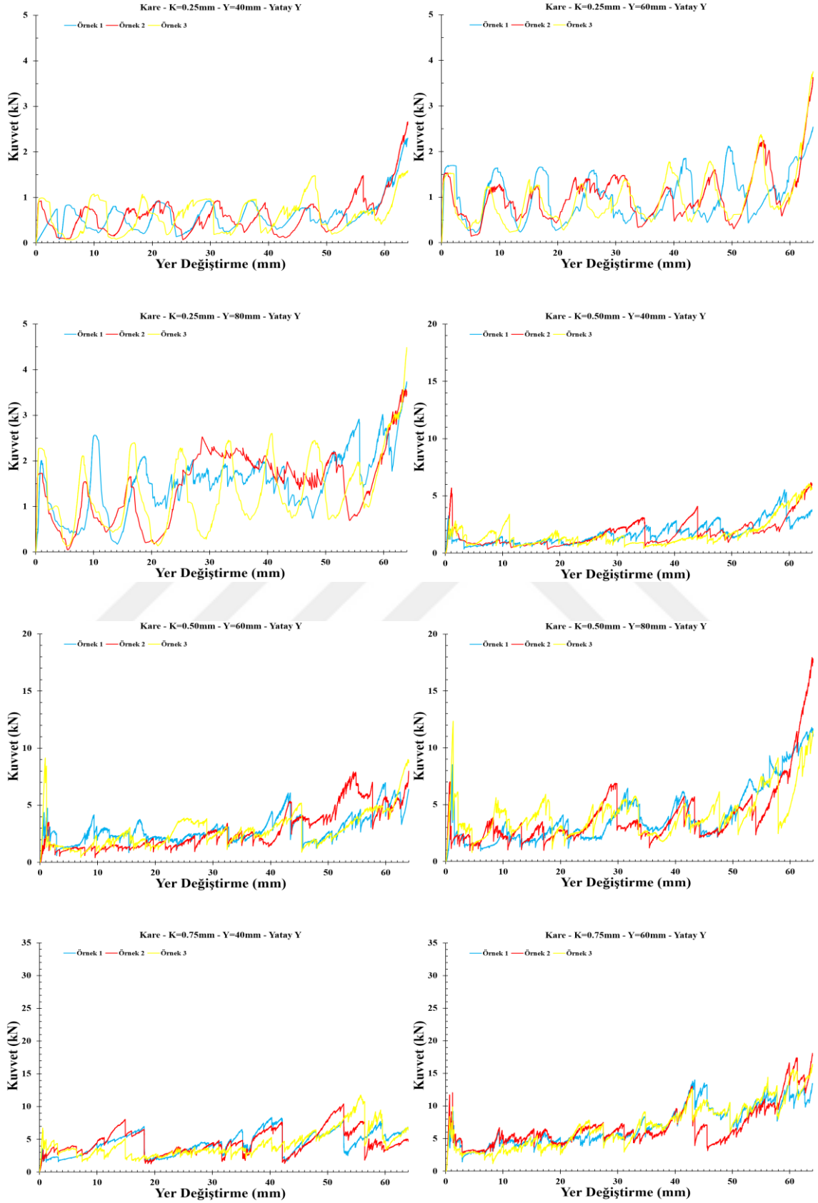
Şekil Ek- 2. Düzlem İçi Genişleme yönündeki Kuvvet-Yer Değişirme Grafikleri
