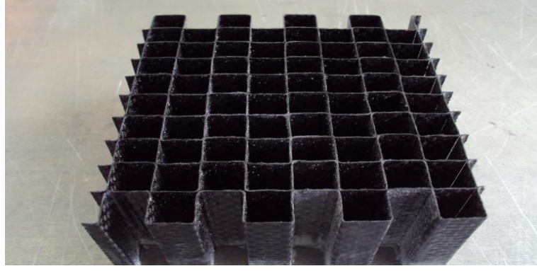
Resim 2.16. 0,25 mm kalınlıkta 80x80x40 mm ölçülerinde kare deney numunesi
