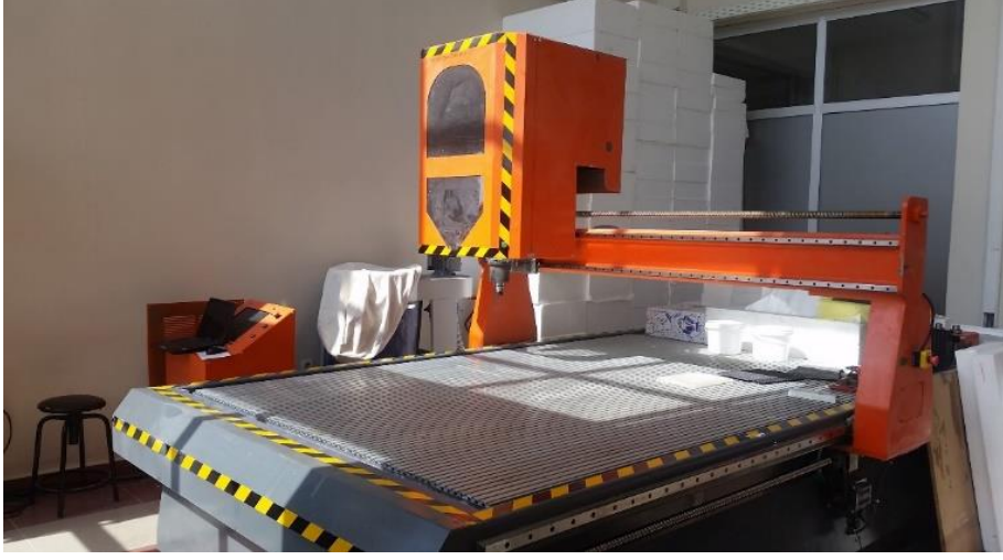
Resim 2.4. PROBOTSAN marka CNC dikifleme merkezi
