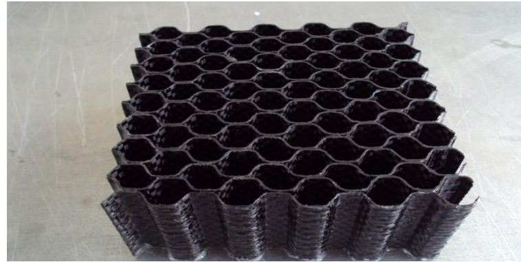
Resim 2.18. 0,25 mm kalınlıkta 80x80x40 mm ölçülerinde altıgen deney numunesi
