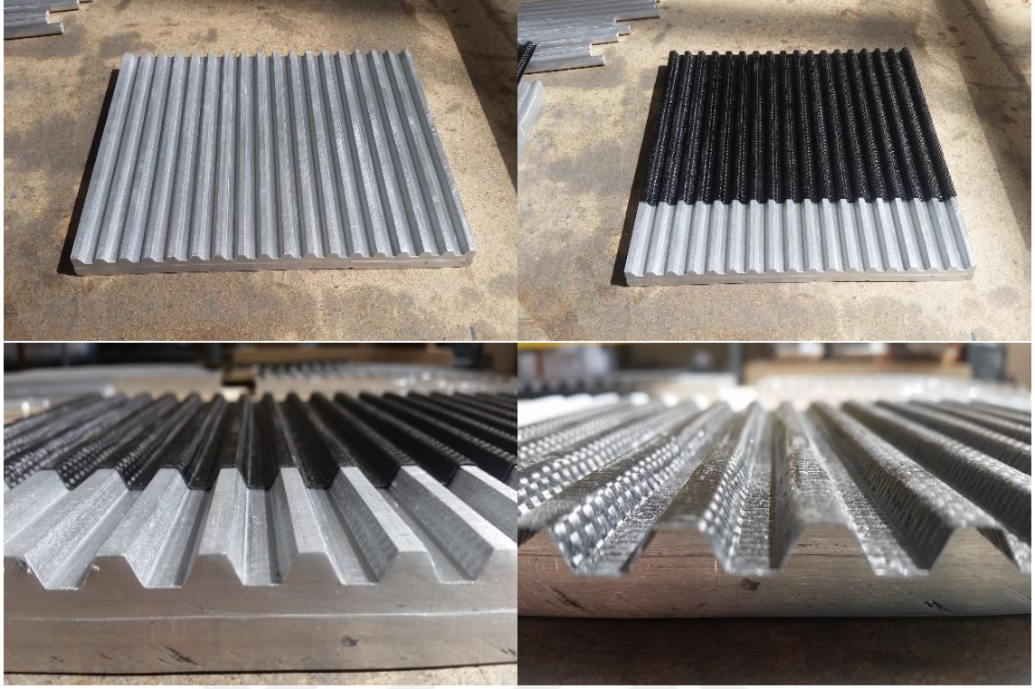
Resim 2.12. Altıgen model oluklu levha
