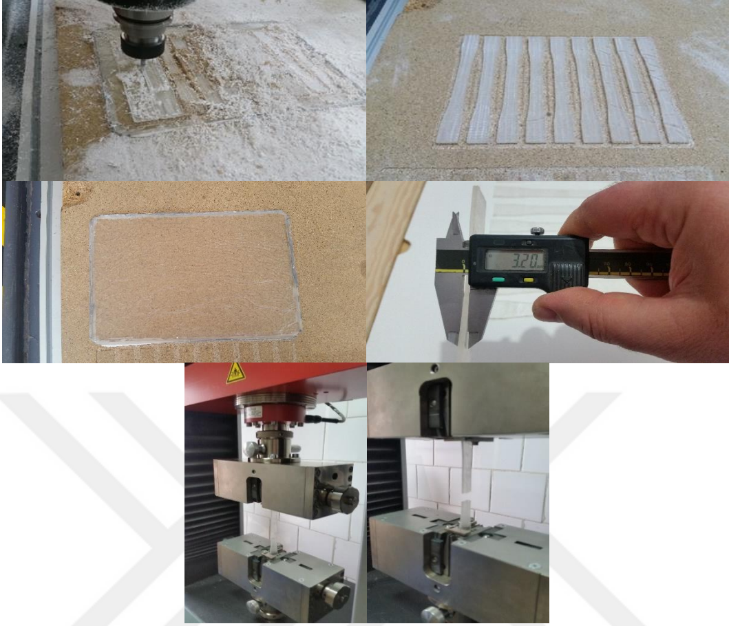
Resim 3.2. Epoksi reçine çekme numunelerinin hazırlanması ve örnek çekme deneyinden görüntüler
