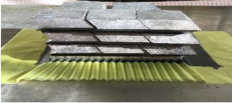
Resim 2.9. 100 kg yük altında kalıp içerisinde kürlenme sürecinin gösterimi
