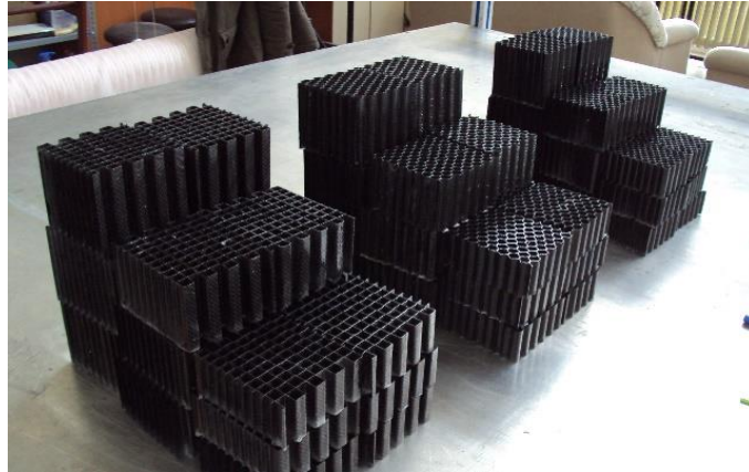
Resim 2.14. 0,25 \text{ mm} kalınlıkta kare, daire ve altıgenden oluşan 54 adet test numunesi
