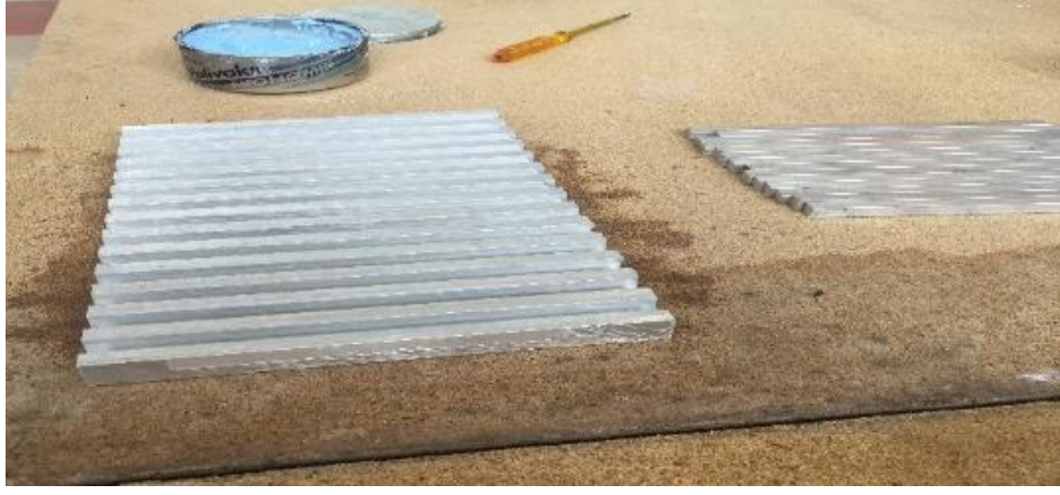
Resim 2.6. Kare kalıba krem vaks uygulanması
