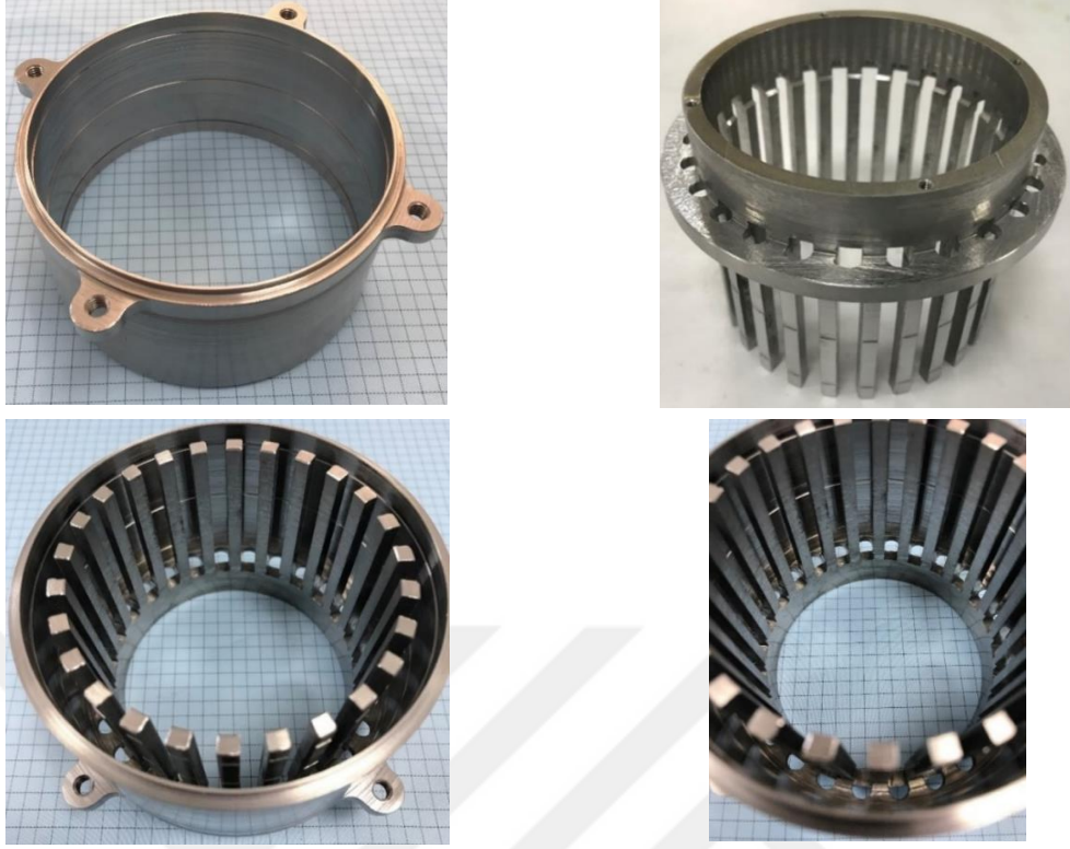
Şekil 3.9. DR’de sabit bulunan dış kovan ve dış destek montajı
