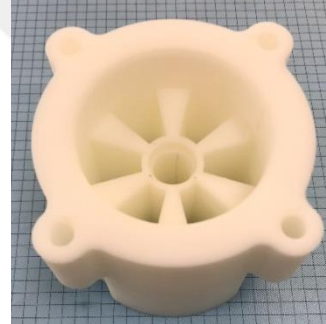
Şekil 3.4. MD İR montajı için mıknatıs tutma aparatı
