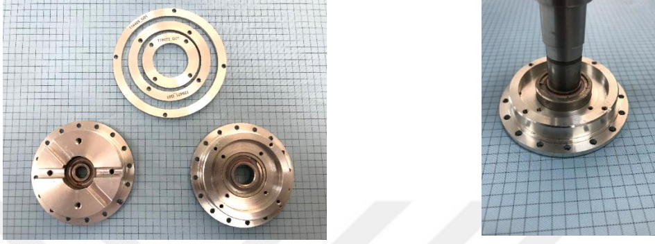
Şekil 3.15. OR ve İR arasında kullanılan rulmanların montajı
