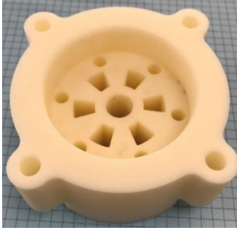
Şekil 3.4. MD İR montajı için mıknatıs tutma aparatı
