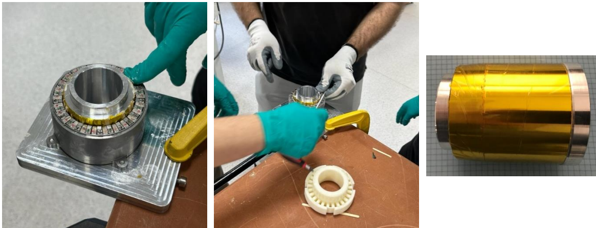
Şekil 3.12. DR mıknatıslarının aparat ile montajlanması
