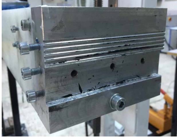
Resim 3.3. Gerdirme mekanizmasının bağlantı yeri
