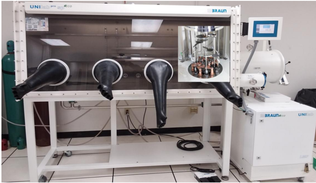
Őekil 2.6. Omik ve dođrultucu kontađın oluřturulduđu glowbox sistemi
