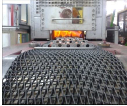
Şekil 2. Örgülü bir tel üzerinde sürekli bir atmosfere giren test parçaları ve fırın.
