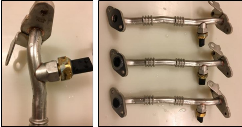
Şekil 2.48 saat korozyon testi uygulanmış EGR numuneleri
