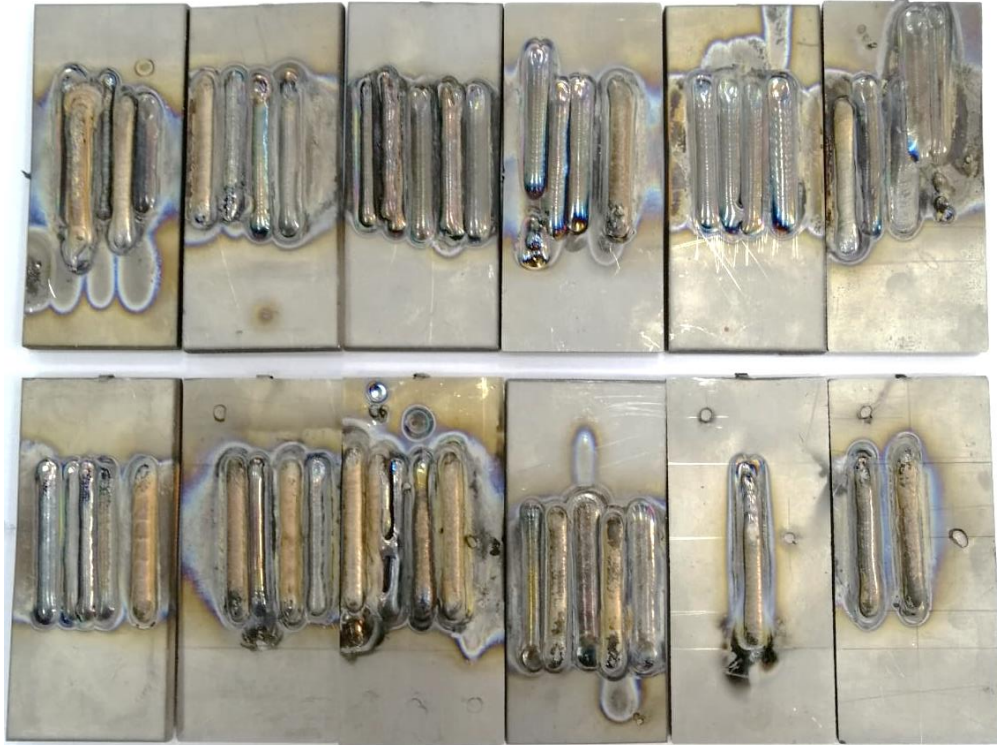
Resim 2.5. Tasarlanan TIG-TAEİ cihazı ile üretilen deneme numunesi örnekleri
