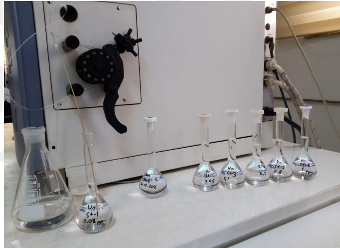
Resim 3.11. ICP-OES cihazı ve kalibrasyon çözeltileri
