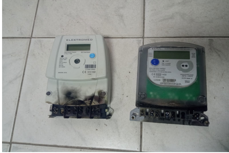
Şekil 3.10. Kaza sonrası aynı bölgelerde görülen yanık izleri
