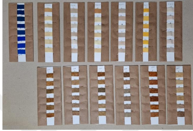
Şekil 2.10. Işık haslığı için hazırlanan mavi yün referans kumaşlar ve boyanmış kumaşlar
