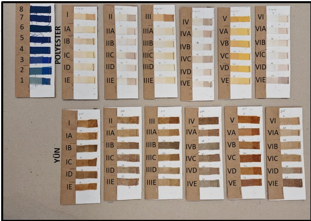
Şekil 3.135. Sentezlenen boyarmaddeler ile boyanmış kumaşlar ve standart mavi yün kumaşlar
