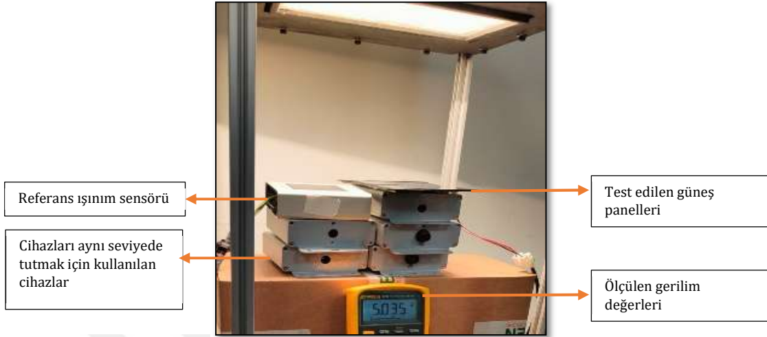
Resim 3.6. Referans ışınım sensörü ve panellerin eş düzlemlilikte konumlandırılması
