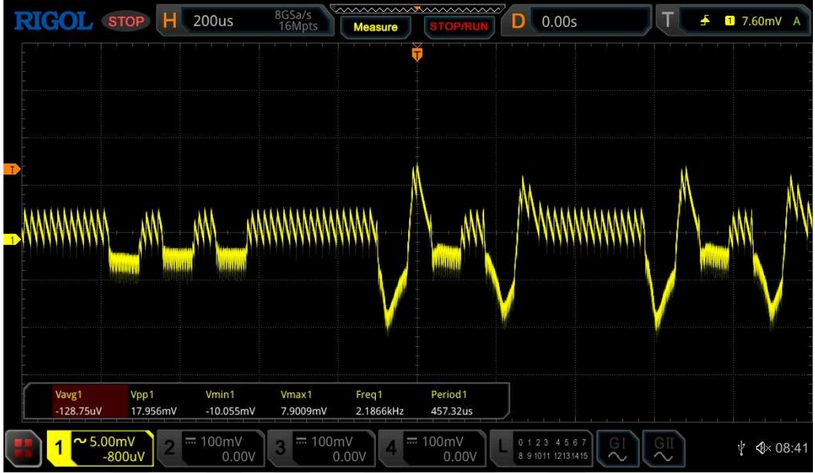
Şekil 3.1. ESP32 modülünün 3.3V girişinin osiloskop görüntüsü
