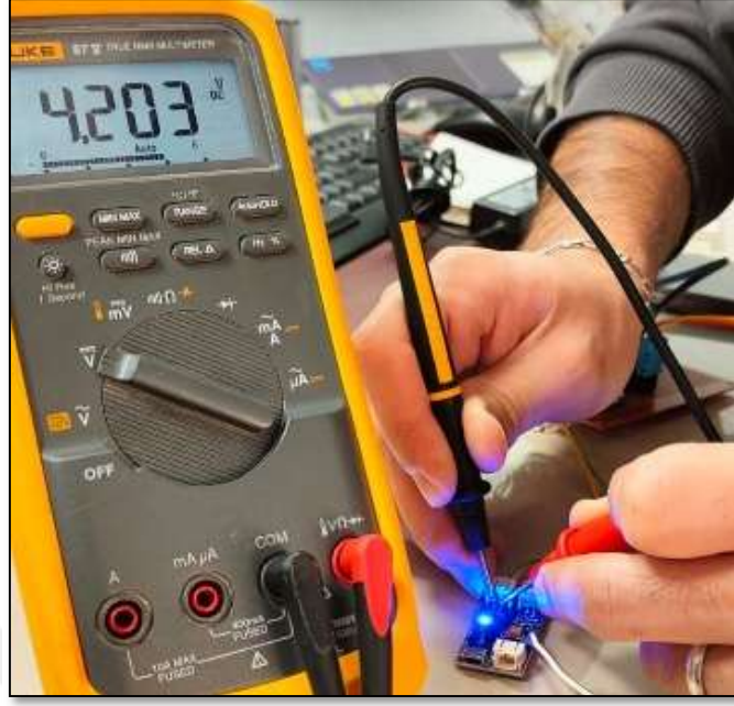
Resim 3.3. Güneş paneli şarj devresi testi
